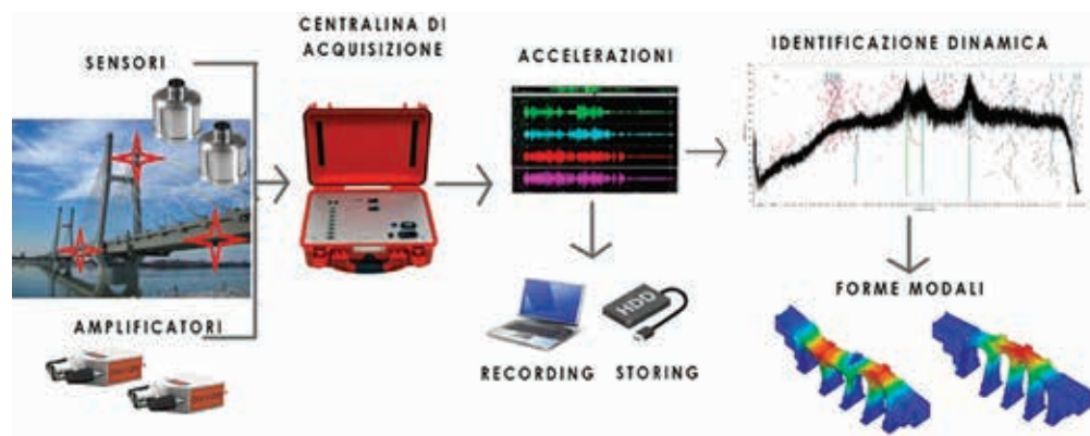
Fig. 4 | Catena di misura
